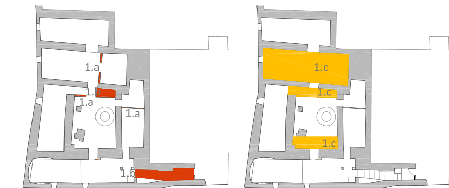
1.a. Estudio y Demolición de tabiquerías y/o elementos añadidos. 1.b. Demolición de escaleras.
